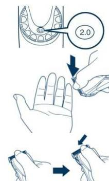
Zum *Befestigen* des Schermessers stellen Sie den Wahlschalter auf „2.0“. Setzen Sie den Befestigungshaken in die Schermesserbefestigung am Haarschneidegerät ein und schieben Sie, bis ein Klicken zu hören ist.
